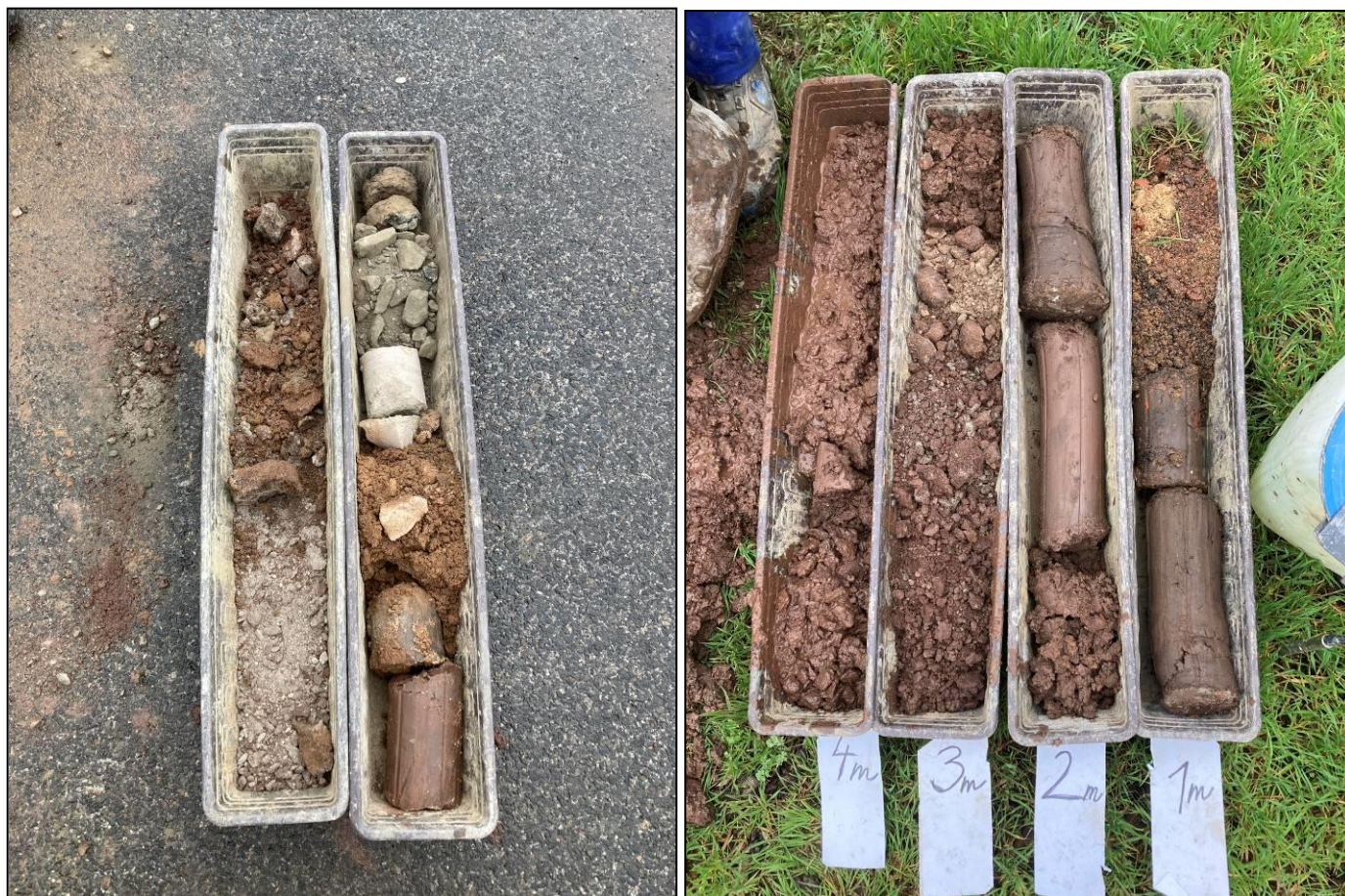
Obrázek č. 3: Fotodokumentace geologického jádra se sondy J-1 (vlevo) a J-2 (vpravo)
