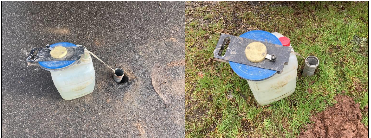
Obrázek č. 4: Fotodokumentace orientačních nálevových zasakovacích zkoušek
